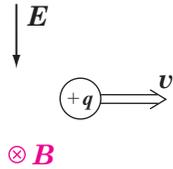
(解答) 右図に示すように、 $+q$  (C) の荷電粒子に働く力は、上向きに  $f_1 = qvB$  と下向きに  $f_2 = qE$  の2つだけだね。よって、この2つが等しいとき、この荷電粒子に働く合力は  $\mathbf{0}$  となって等速直線運動を続けることができる。よって、
